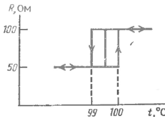
Приложив к резистору постоянное напряжение  $60\ \text{В}$ , Глюк заметил, что через резистор течет постоянный ток, а его температура равна  $80^{\circ}\text{C}$ . Приложив же напряжение  $80\ \text{В}$ , Глюк заметил, что текущий через резистор ток меняется с периодом  $1\ \text{с}$ . Считая теплоемкость резистора постоянной, определите ее, если температура воздуха в лаборатории Глюка  $20^{\circ}\text{C}$ .
