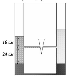
уровни жидкости в левом и правом сосудах (отсчитываемые от верхней трубки) через большое время после того, как кран Капиллярными открыли. эффектами пренебречь, диаметры соединительных трубок много меньше диаметра сосудов, ПЛОТНОСТИ воды, ртути керосина  $1.0 \, \Gamma/\text{cm}^3$ ,  $13.6 \, \Gamma/\text{cm}^3 \, \text{и} \, 0.8 \, \Gamma/\text{cm}^3$  соответственно. Высота сосудов достаточна для того, чтобы жидкость не переливалась через край.
